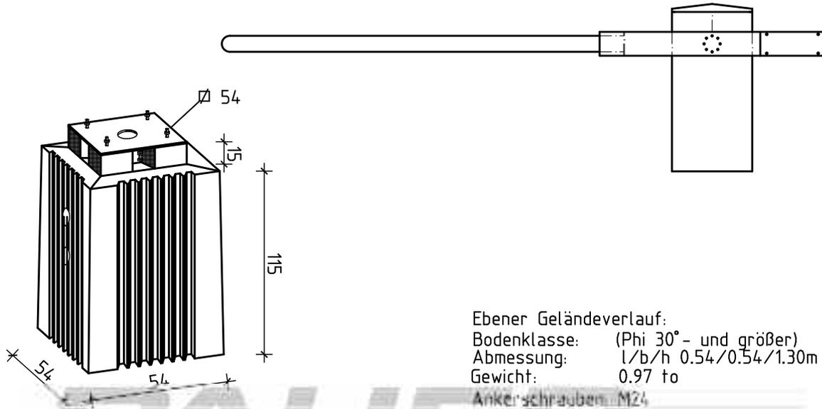
Fertigteilefundament für Schranken Antrieb Baumlänge 7.0 bis 10.0m
