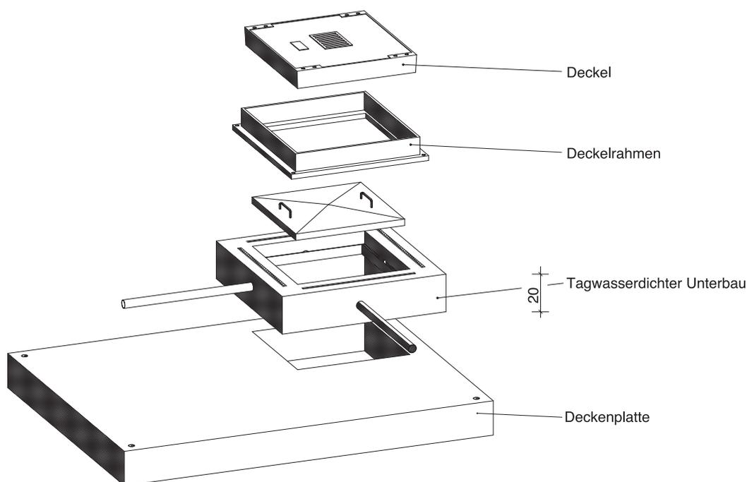
Der tagwasserdichte Unterbau stellt einen dauerhaften, sicheren und flexiblen Schutz gegen Eindringen von Oberflächenwasser oder Flüssigkeiten dar. Er schützt die darunter liegenden Anlagen vor Eindringen von Oberflächenwasser und vor Anschlägen mit brennbaren oder aggressiven Flüssigkeiten.
