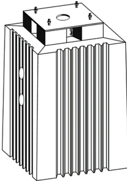
kleine Bauform: Abstand Gewindeanker = 280 mm, Stahlplatte 400 x 400 mm
